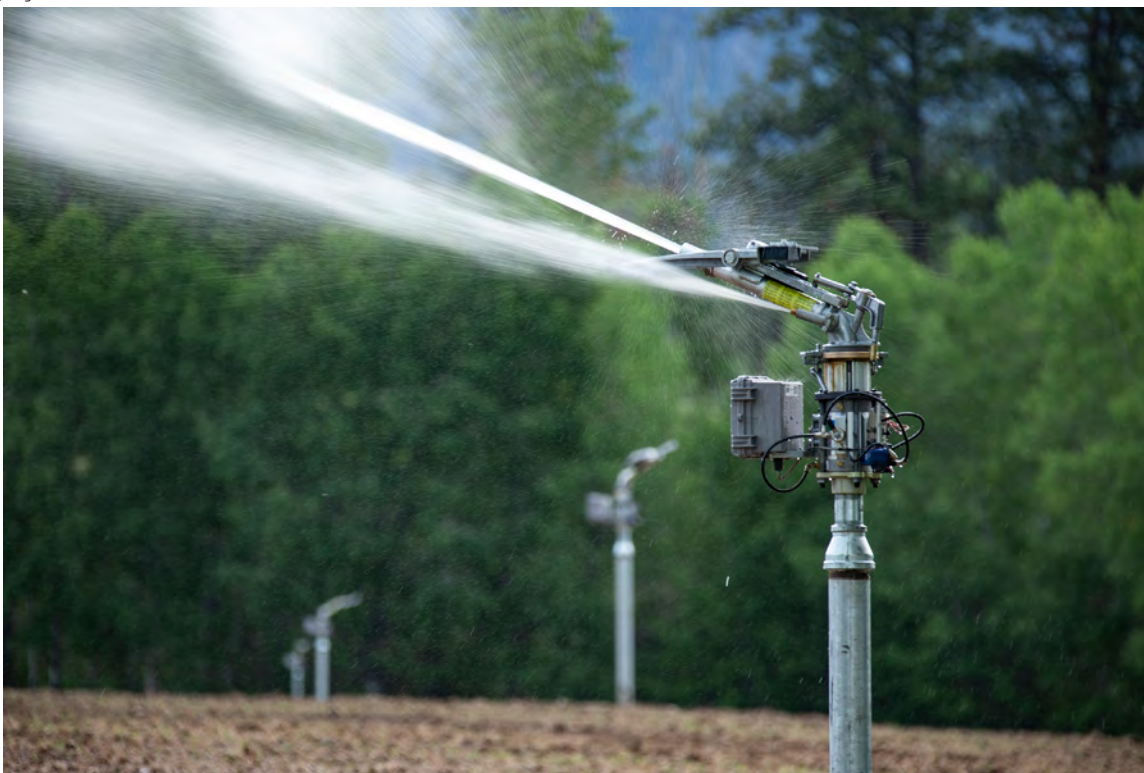
Figure 8. Automação com TWIG® Wireless e válvulas de controle Nelson auxilia a realização de irrigação de precisão com aspersores Big Gun®.
