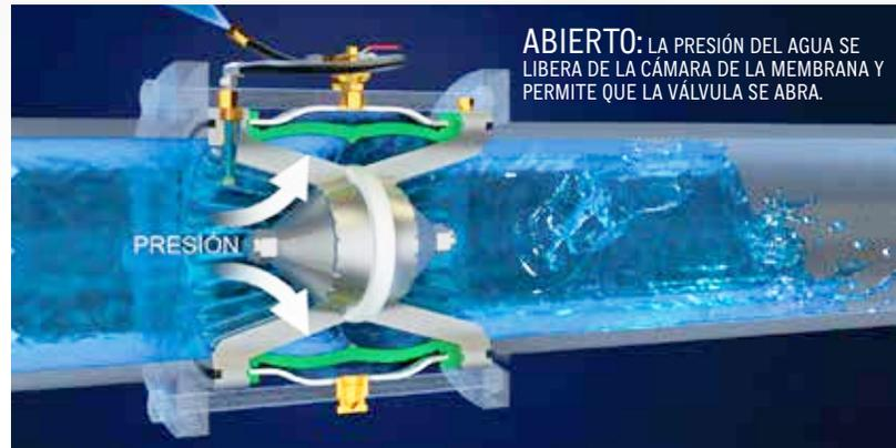
**ABIERTO:** LA PRESIÓN DEL AGUA SE LIBERA DE LA CÁMARA DE LA MEMBRANA Y PERMITE QUE LA VÁLVULA SE ABRA.
