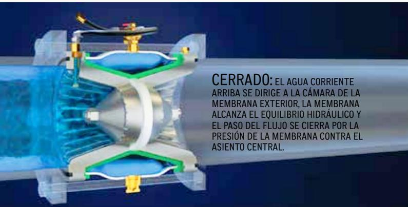
**CERRADO:** EL AGUA CORRIENTE ARRIBA SE DIRIGE A LA CÁMARA DE LA MEMBRANA EXTERIOR, LA MEMBRANA ALCANZA EL EQUILIBRIO HIDRÁULICO Y EL PASO DEL FLUJO SE CIERRA POR LA PRESIÓN DE LA MEMBRANA CONTRA EL ASIENTO CENTRAL.
