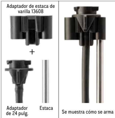
La opción de estaca de varilla necesita el adaptador (13608) de estaca de varilla universal y la estaca de fibra de vidrio o de acero. Utilice la herramienta universal de instalación de estacas de acero (14000) para proteger el conjunto mientras clava la estaca en el suelo.
