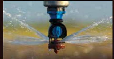
SCHLAUCHFÜHRUNG – BUBBLER – ZERSTÄUBERTECHNOLOGIE EIGNEN SICH ALS LEPA UND LESAs, SOFERN DIE AUSLASSABSTÄNDE KURZ SIND UND DIE VORRICHTUNGEN DAS WASSER NAHE AN ODER AUF DER BODENOBERFLÄCHE MIT GERINGEM ENERGIEVERBRAUCH ABGEBEN, DAMIT NUR SEHR WENIG WASSER VERDUNSTET.
