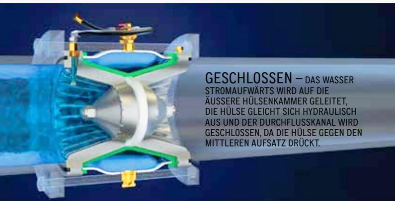
**GESCHLOSSEN** – DAS WASSER STROMAUFWÄRTS WIRD AUF DIE ÄUSSERE HÜLSENKAMMER GELEITET, DIE HÜLSE GLEICHT SICH HYDRAULISCH AUS UND DER DURCHFLUSSKANAL WIRD GESCHLOSSEN, DA DIE HÜLSE GEGEN DEN MITTLEREN AUFSATZ DRÜCKT.
