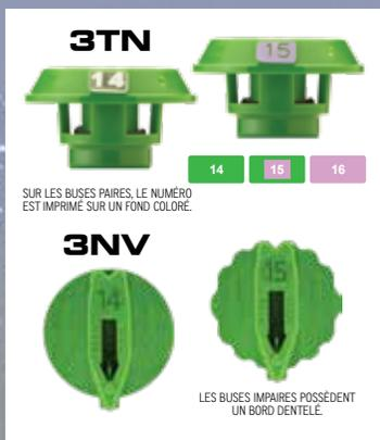
Les tailles de buse sont étagées par incréments de 1/128 po. Par exemple, le diamètre de l'orifice de la buse 3TN/3NV N° 26 est de 26/128 po tandis que celui de la buse 3TN/3NV N° 27 est de 27/128 po. Dans la gamme de buses 3TN, le numéro de référence est encadré en couleur sur les buses impaires. Ce cadre coloré correspond à la couleur de la buse de taille immédiatement supérieure. Les buses 3NV impaires sont dotées d'un bord dentelé et n'affichent pas de couleur secondaire.
