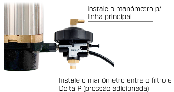
Figure 4. Localização dos Manômetros para checagem de apoio na solução de problemas
