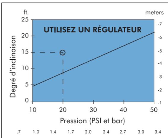
**Exemple:** À une élévation de 4,6 m et une pression de 1,4 bar, les régulateurs de pression sont indispensables.
