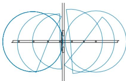
L'installation sur cannes de descente nécessite une orientation précise des arroseurs à secteur
