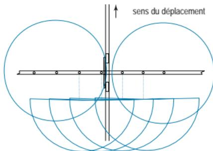
L'installation sur rampes décalées résout les problèmes d'uniformité typiques des arroseurs à secteur
