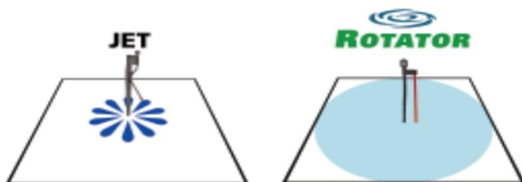
L'asperseur Rotator distribue l'eau uniformément et offre une pluviométrie adaptée à la vitesse d'absorption du sol.
