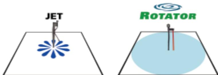
El aspersor Rotator distribuye el agua de manera uniforme y con una pluviometría adaptada a la tasa de absorción del suelo.
